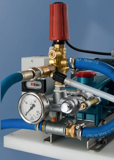
Die Reinigungsgeräte arbeiten mit einer robusten Dreikolbenpumpe. Sie läuft in einem selbstschmierenden Ölbad. Die Pumpe ist für einen Dauerbetrieb mit max. 70°C ausgelegt. Der Druck ist stufenlos regelbar.
